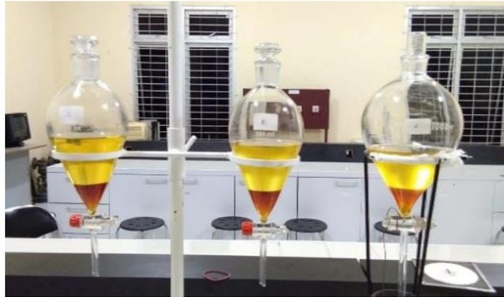
Gambar 1. Warna biodiesel hasil reaksi transesterifikasi minyak jelantah dan methanol 1: 5 massa dengan katalis NaOH 0,6 % massa berdasarkan perbedaan waktu reaksi 35, 40 dan 45 menit pada suhu 60°C.
